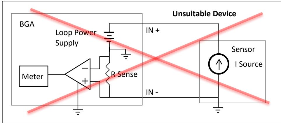
FIGURE 10: CURRENT INPUT W/ LOOP POWER (UNSUITABLE DEVICE)
